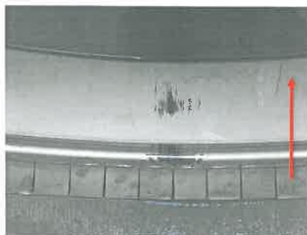
Bild 10: EPDM Manschette DN 800 nach 60 Zyklen – Detail; der Pfeil gibt die Spülrichtung an
