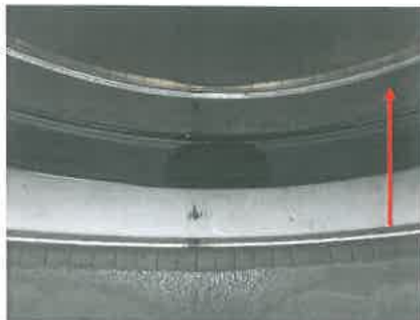
Bild 8: EPDM Manschette DN 800 nach 60 Zyklen; der Pfeil gibt die Spülrichtung an
