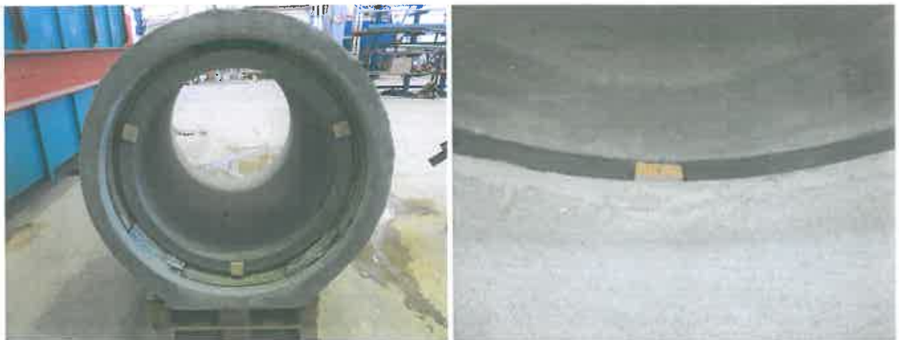
Bild 5: Teilweise entfernte Dichtungen und aufgeklebte Holzplättchen
